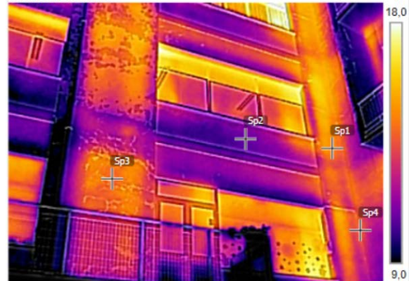
Figura 4.3 – Rilievo termografico della parete interno cortile con esposizione sud-ovest
